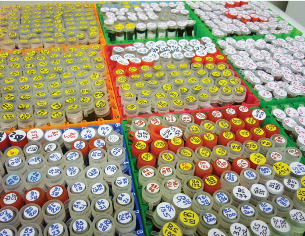
Abbildung 3. In der VET-GEN-BERN Sammlung des Instituts für Genetik in Bern sollen handgeschriebene Etiketten durch maschinenlesbare Barcodes ersetzt werden, um das Risiko von Probenverwechslungen zu minimieren. Ein zentralisiertes Biobanking mit einheitlichen technischen Lösungen für die Probenbeschriftung könnte für die Vetsuisse-Fakultät eine Kostenersparnis gegenüber zahlreichen Einzellösungen bringen.
