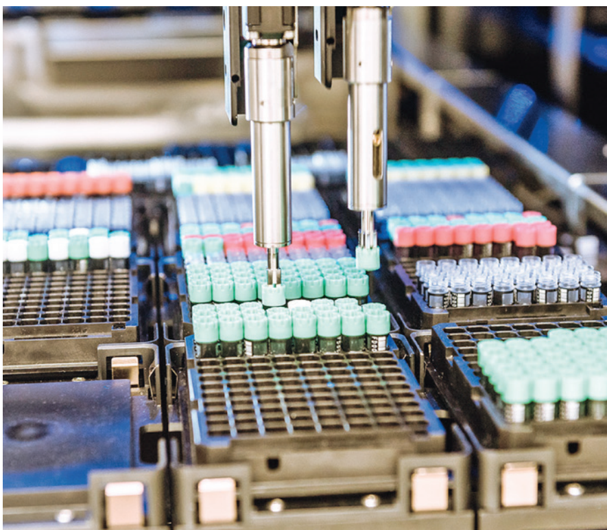
Abbildung 4. Moderne Biobank für flüssige Proben am Inselspital Bern (Foto mit freundlicher Genehmigung von Dr. Ursula Amstutz). Hier können Millionen von Probengefässen mit 2D-Barcodes vollautomatisch bewegt und unter genau kontrollierten Bedingungen eingefroren und wieder aufgetaut werden.
