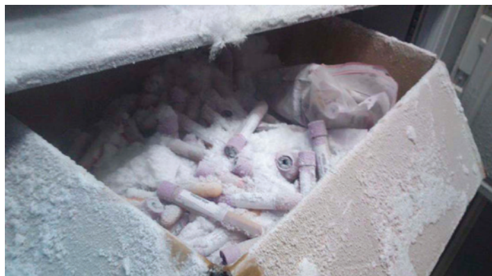
Abbildung 1. Extrembeispiel aus dem Alltag im Biobanking. Nach einem Personalwechsel wurden wertvolle Proben beim Aufräumen eines -80 °C Kühlschranks «wiederentdeckt». Unsachgemässe Einlagerung hatte zu einer massiven Vereisung geführt, welche das Identifizieren der Proben erschwerte.
